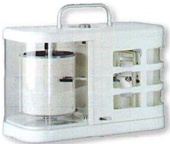
Figura 2 - 12. Termógrafo para exteriores
