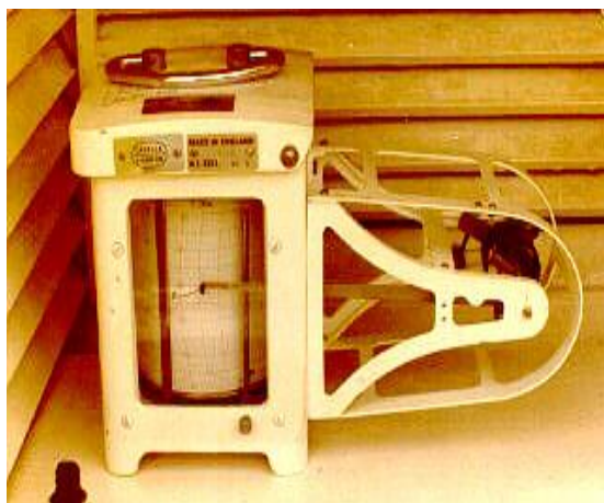
Figura 2 - 11. Termógrafo para interiores
