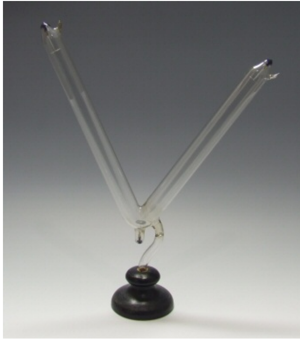
Figura 15.6. Dispositivo para comprobar la propagación rectilínea de los rayos catódicos.
