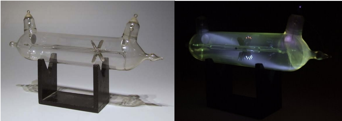
Figura 15.9. Dispositivo de Crookes para comprobar la acción mecánica de los “rayos de materia”.
