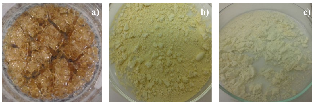
Figura 3. Geles secos sintetizados con CX_4SO_3H a temperatura ambiente: a) CX_4SO_3H-Si ; b) CX_4SO_3H-Ti ; c) CX_4SO_3H-Si-Ti .
