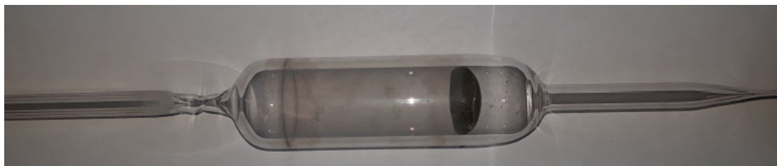
Figura 2. Cápsula utilizada para crecer monocristales según el método de Bridgman.
